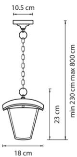
Схема с габаритными размерами
